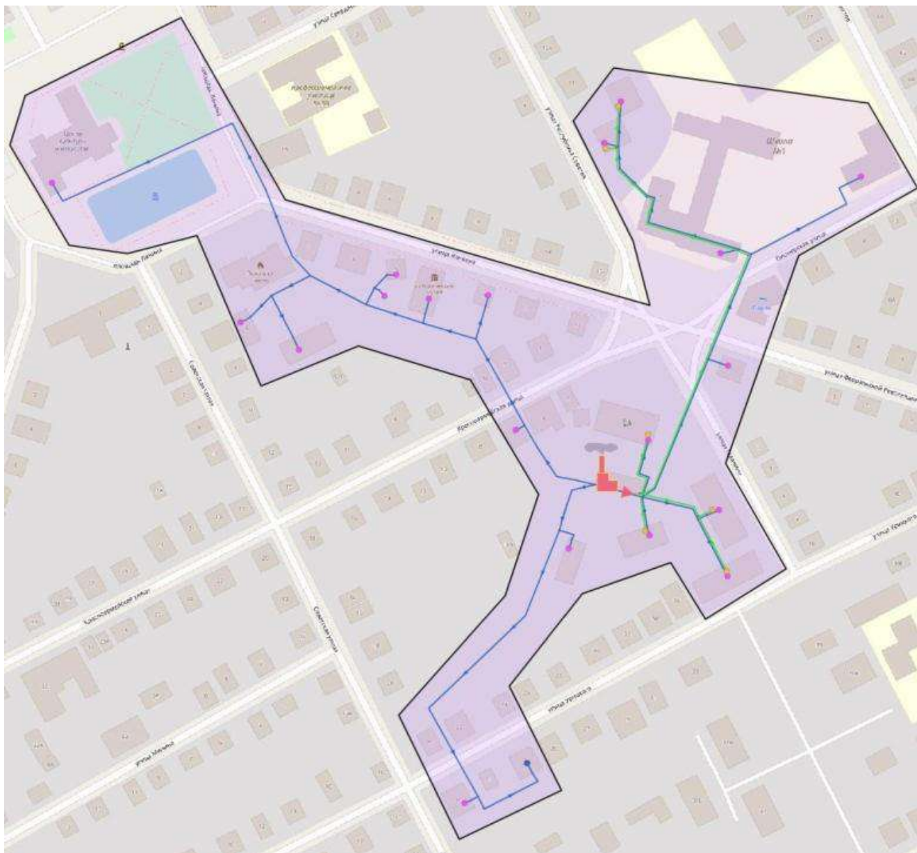
Рис.2. Тепловые сети Котельная №2, пл. Б. Корнилова, стр. 1/5
