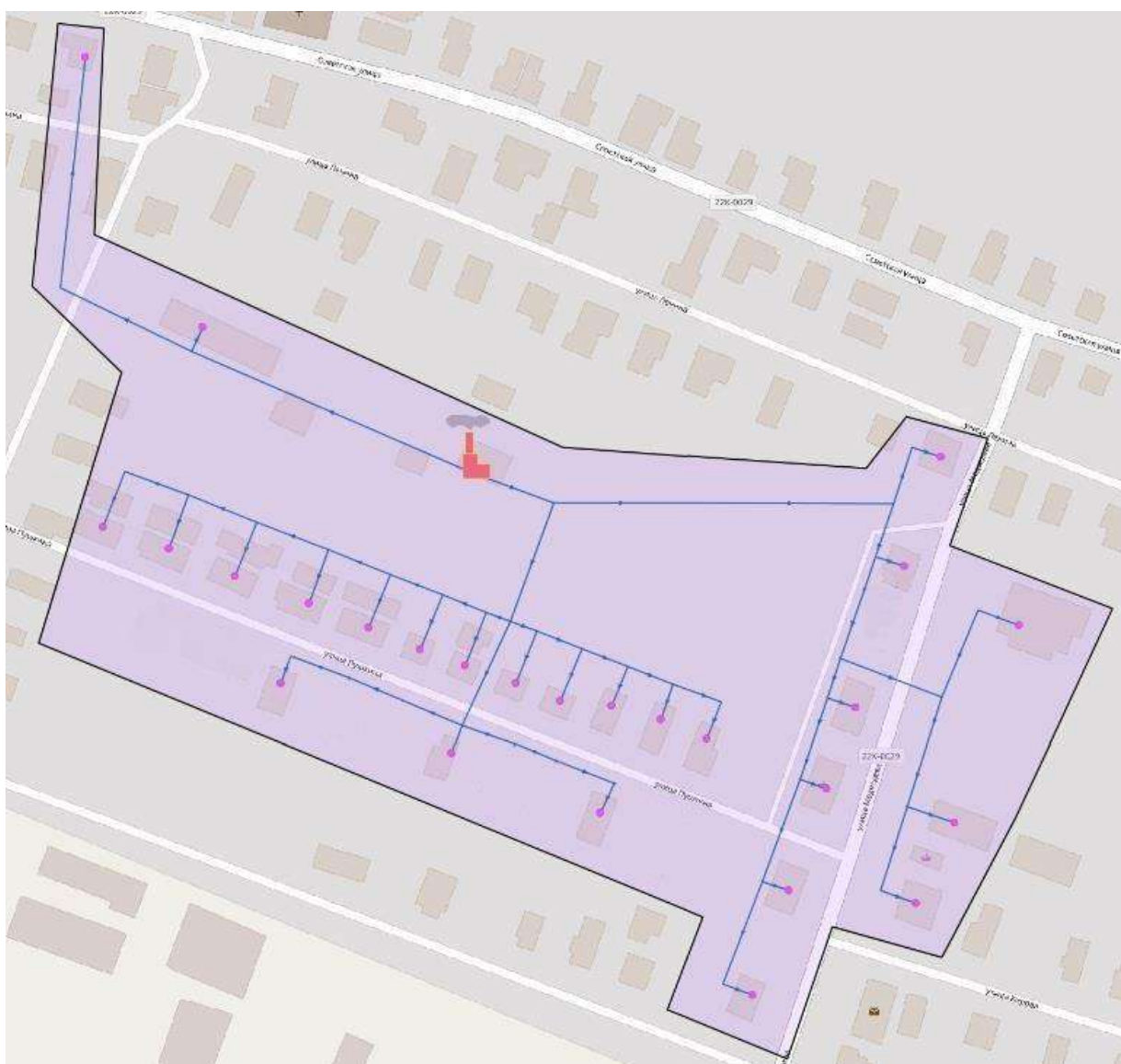
Рис.41. Тепловые сети котельной с. Ильино-Заборское ул. Ленина д.23Б
