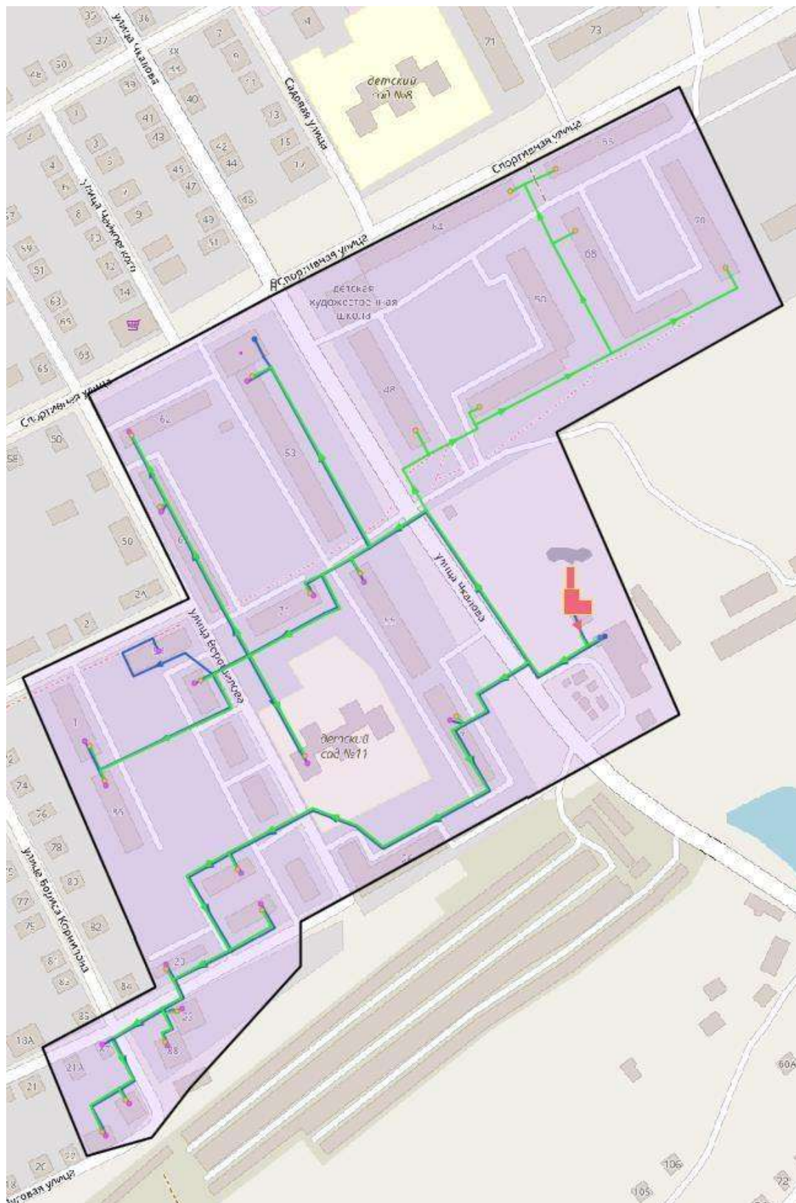
Рис.3. Тепловые сети Котельная №4, ул. Чкалова, 50/3
