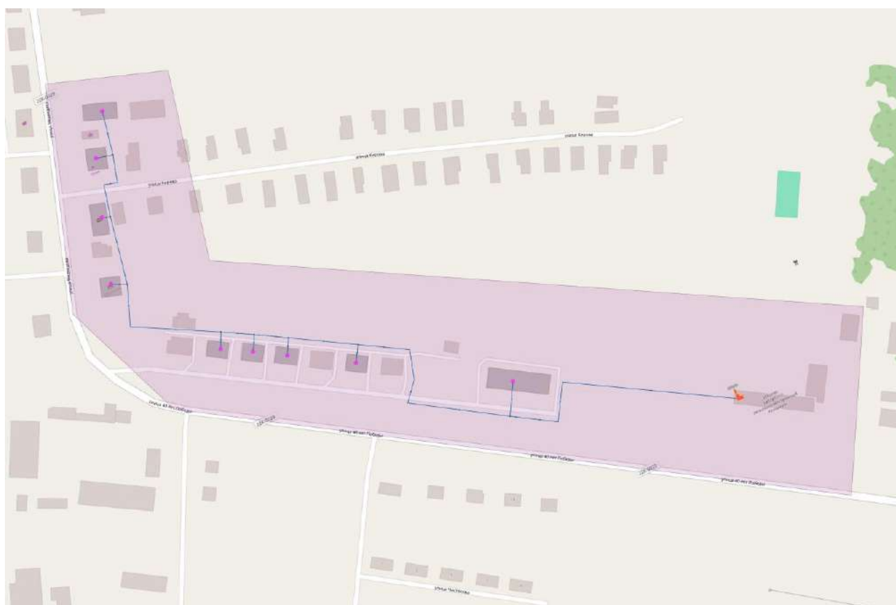
Рис.36. Тепловые сети котельной ООО "Залесное"
