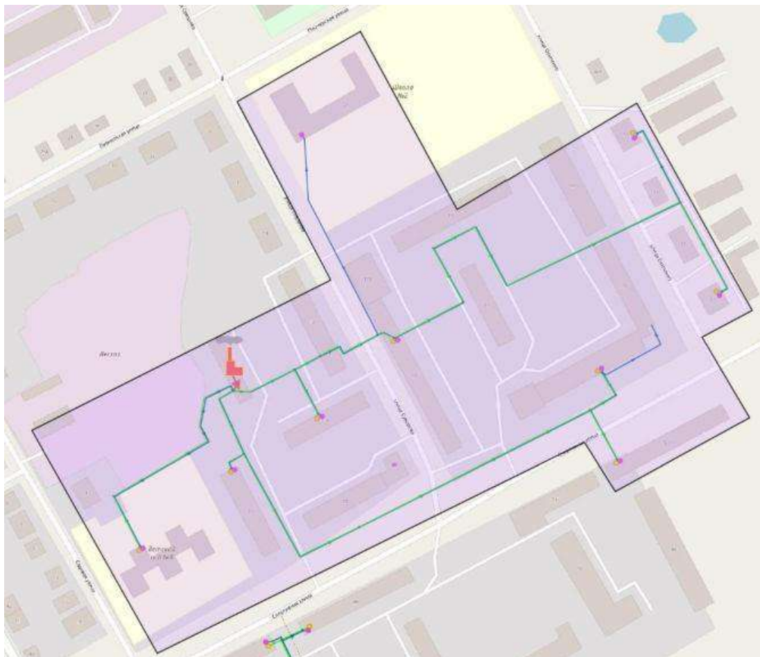
Рис.14. Тепловые сети Котельная №15, ул. Суворова, д. 12/1
