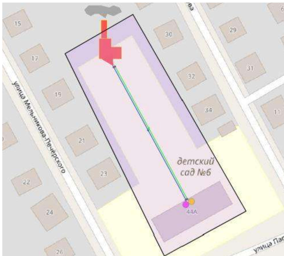
Рис.26. Тепловые сети Котельная №27, ул. Папанина, стр. 44а/1
