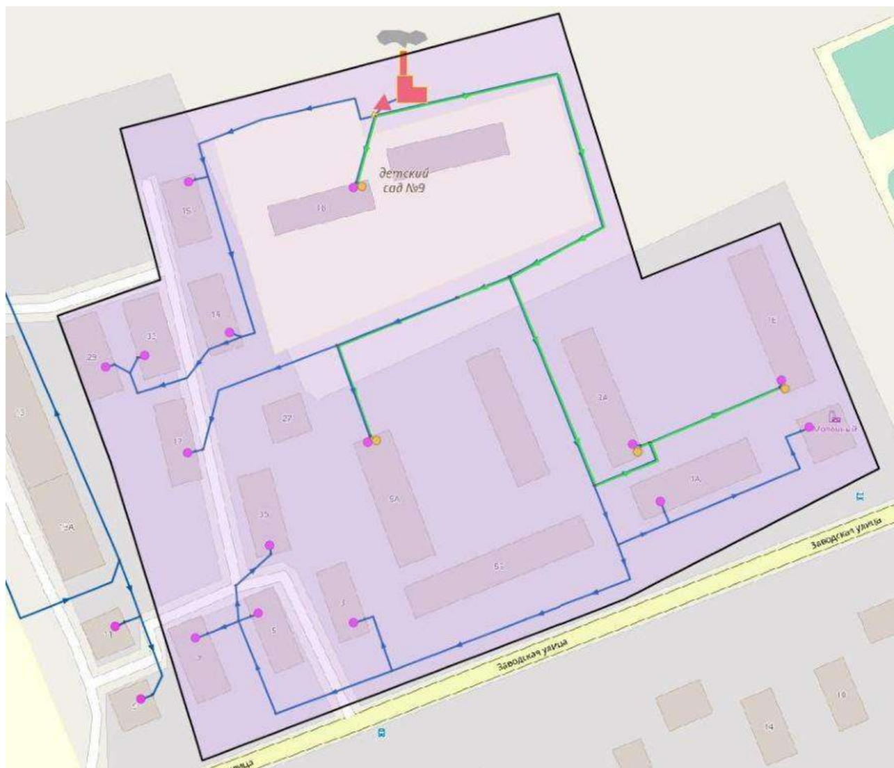
Рис.16. Тепловые сети Котельная №17, ул. Заводская, стр. 1/3
