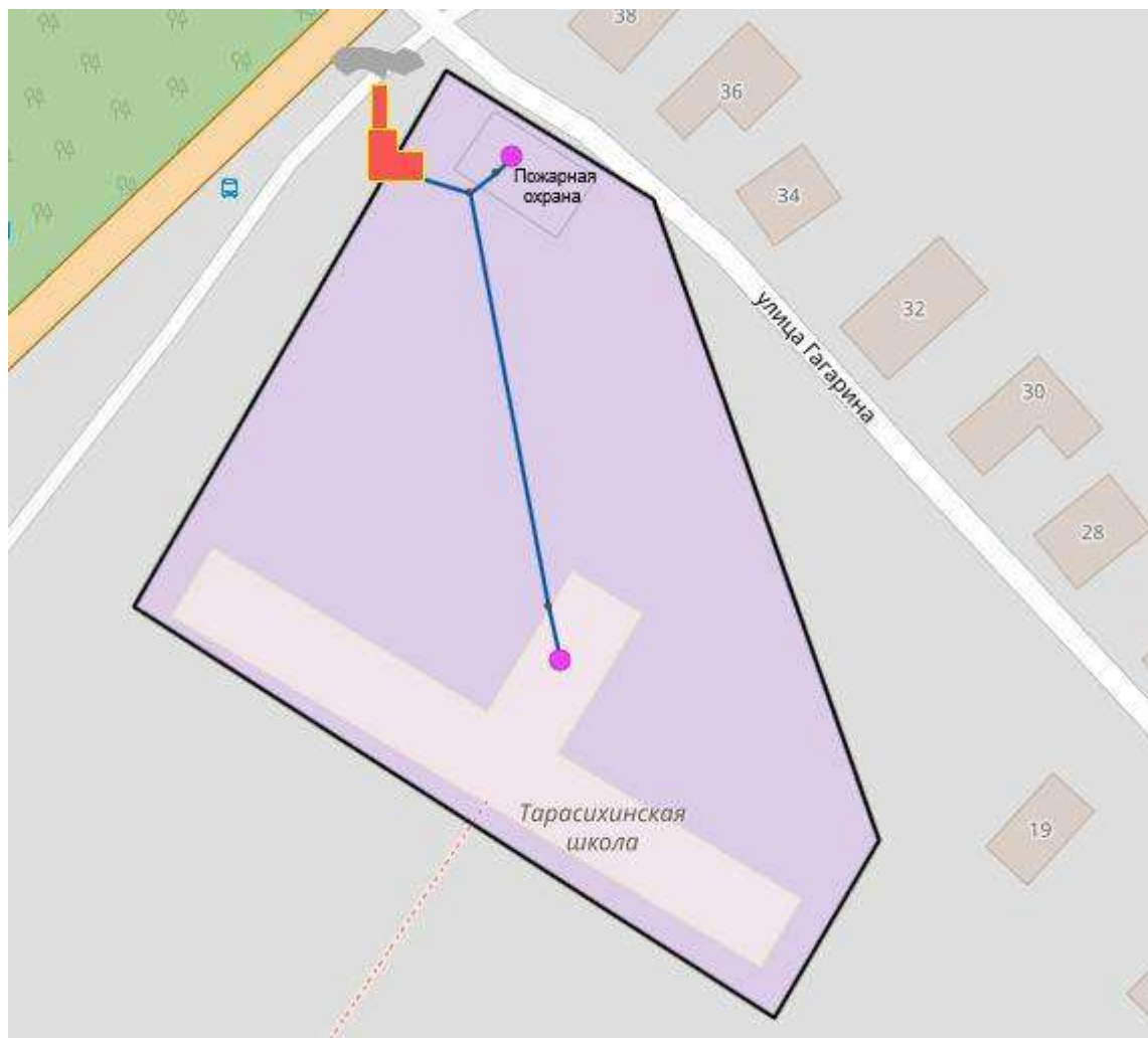
Рис.48. Тепловые сети котельной ст. Тарасиха
