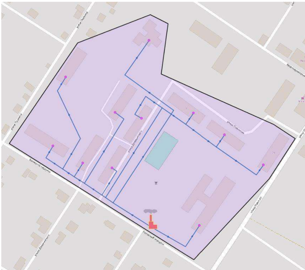
Рис.38. Тепловые сети котельной 2 ООО "Сухобезводнинское ЖКХ"
